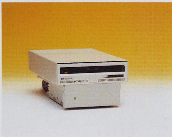
Die Caddy-Station ersetzt die TT- oder Mega STE-Festplatte und bietet Platz für ein zusätzliches 5,25-Zoll-Laufwerk
